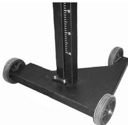
Położenie głowicy pomiarowej jest regulowane w pionie, a jej ciężar zrównoważony za pomocą sprężyny. Głowica pomiarowa umieszczona jest na prowadnicy ze skalą, służącą do dokładnego ustawienia głowicy w stosunku do światel samochodowych.
