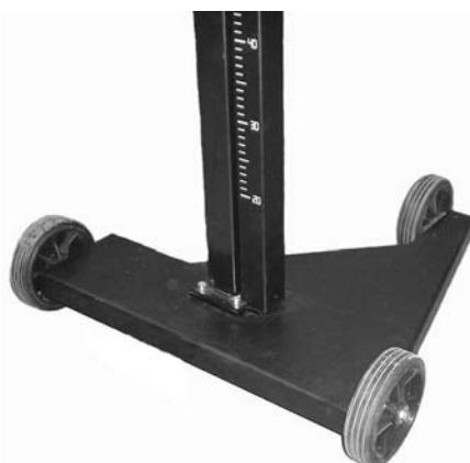
La chambre optique est réglable en hauteur grâce à un système de coulissolement sur patins en plastique précis et silencieux et équilibrée par un ressort, installé à l'intérieur d'un capot en tôle sur lequel est reporté une échelle centimétrique pour un positionnement parfait par rapport au phare.
