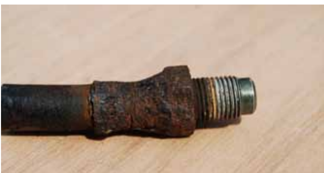
Breuk als gevolg van corrosie.
