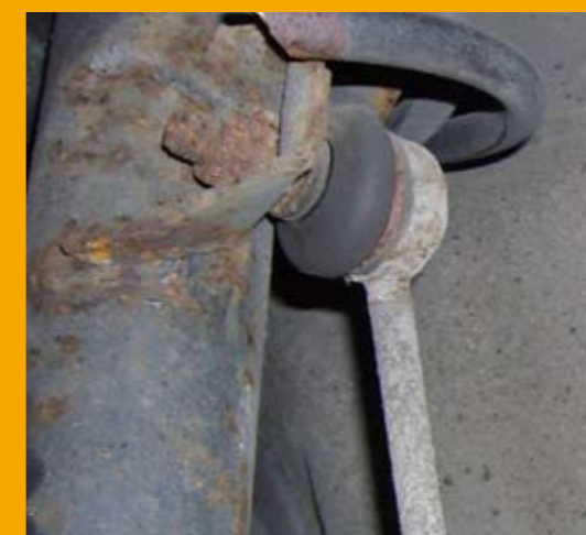
Gebroken veer die zelfs de band kan raken
