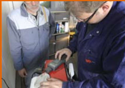
Aansluiten van de roetmeter.
